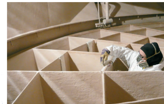
Aplikace povrstvení rotoru Rotor lining application
