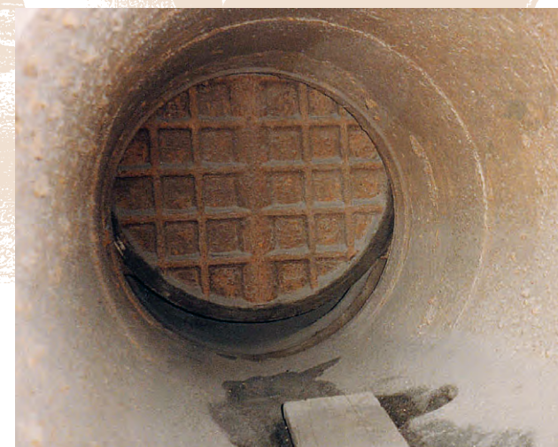
Zkorodovaný vnitřní povrch potrubí Corroded internal piping surface
